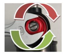
Le réglage de la **compression haute vitesse** s'actionne à l'aide d'une clé de 17. Ce réglage possède environs 5 tours.
