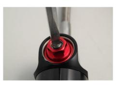
Le bloc de réglage en compression P2S se décompose en deux réglages : la basse vitesse et la haute vitesse. Les effets de ces réglages seront détaillés dans une autre partie.
